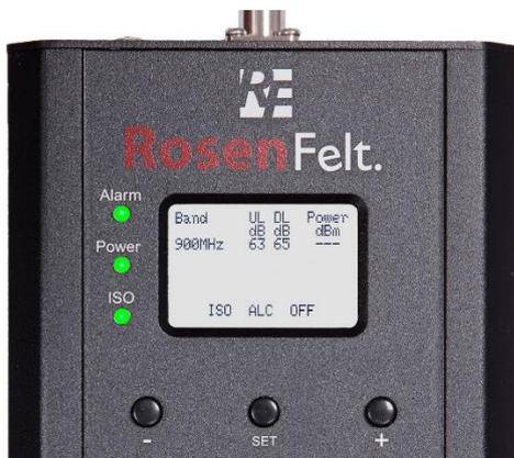
I ripetitori modello H sono forniti con modalità AGC (Automatic Gain Control) preimpostata. Ciò consente al ripetitore di auto-regolarsi a livello ottimale. Quando questo non é possibile, la spia luminosa “ISO” lampeggia. Premere il pulsante “SET” per vedere quali bande di frequenza presentano un problema.
